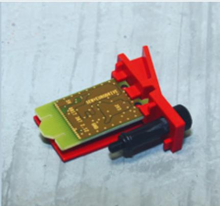
Das „**Steckbare Servicemodul**“ ermöglicht es im Servicefall die integrierte Speicherkarte einfach zu entnehmen und in den neuen MOVIDRIVE® B zu stecken. Alle Geräteeinstellungen werden so schnell und sicher auf den neuen Antriebsumrichter übertragen.
