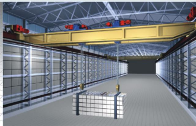
In der Applikation Portalkran übernimmt MOVIDRIVE® B sowohl die Steuerung der beiden Fahrachsen als auch der Hubachse. Die maximale Geschwindigkeit wird lastabhängig begrenzt (Lasterkennung).
