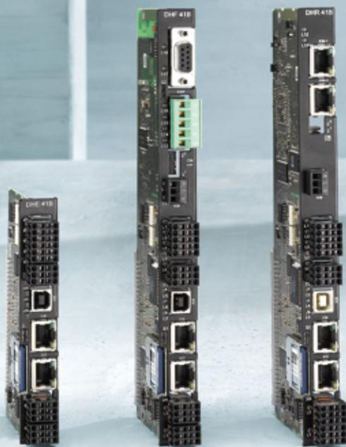
MOVIDRIVE® B-Antriebsumrichter mit integrierter MOVI-PLC® realisieren von der einfachen Einzelachs-funktion bis hin zu Applikationslösungen für mehrere Achsen. So eignet sich z. B. die Steuerungskarte MOVI-PLC® basic DHP11B insbesondere für die Automatisierung von Maschinenmodulen, in denen komplizierte Bewegungsabläufe zu koordinieren sind.
