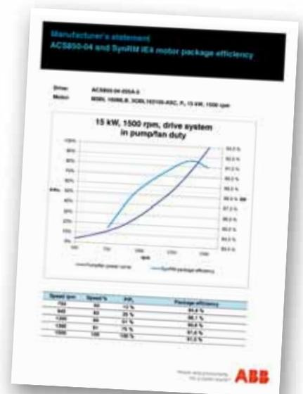
Effizienzdaten für das Antriebspaketes mit Synchronreluktanzmotor und Frequenzumrichter für Pumpen und Lüfter von ABB.
